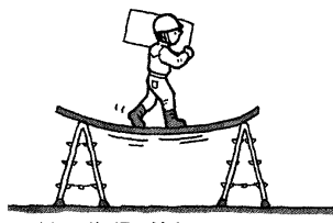
(a) 足場板を 結束しない で作業
