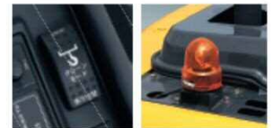
クレーンスイッチ
